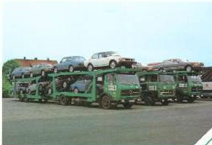
Doppelstöckiger Autotransporter mit abtrennbarem Obergeschoss
