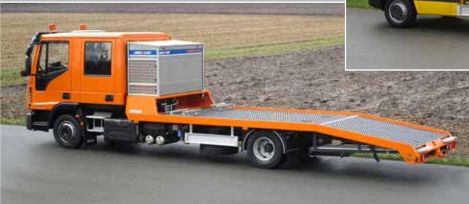
**STAHL- UND ALU-FESTPLATEAUS** bieten eine hohe Nutzlast. Die einfache Handhabung der Rampen ermöglicht ein schnelles Be- und Entladen. Die niedrige Aufbauhöhe ist Grundlage für hohen Fahrkomfort. Mit unserem Zubehörprogramm gestalten Sie das Fahrzeug ganz nach Ihren individuellen Wünschen.
