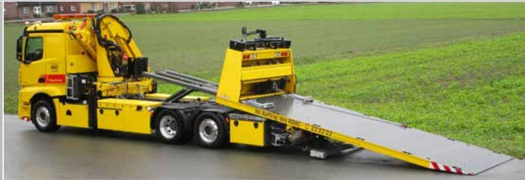
Zum Entladen blockierter Fahrzeuge lässt sich das Plateau steil ankippen. Zur Schonung des Aufbaus sind Funktionen endlagengedämpft. Leistungsfähige Krane und ein reichhaltiges Zubehör machen diese Fahrzeuge zu einem Universalwerkzeug mit sehr guten Einsatzmöglichkeiten.
