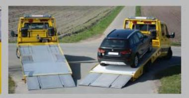
Großzügige Ladeflächen mit ausfahrbaren Rampen Die Ladefläche besteht aus einer rutschfesten Oberfläche. Zurrpunkte auf der Ladefläche sind ausreichend vorhanden. Die Rampen werden hydraulisch ausgefahren.
