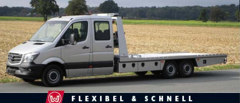
as Wellmeyer Knickplateau ist ein Fahrzeug für den schnellen und flexiblen Autotransport. Geringer Kraftstoffverbrauch und hohe Nutzlast bei geringem Eigengewicht machen den Knicklader zu einem unschlagbaren Helfer in Ihrem Unternehmen. Durch die Eigenkonstruktion des Rahmens und des Aufbaus bleiben Ihnen bei der Ausstattung kaum Wünsche offen.
