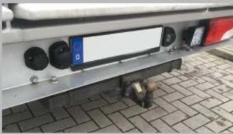
Hydraulisch ausklappbare Kugelkupplung für den Anhängerbetrieb. Für die Fahrt mit einem Anhänger kann über das Bedienfeld die Kugelkupplung hydraulisch ausgefahren werden. Beim Kippen der Ladefläche fährt die Kupplung automatisch ein.
