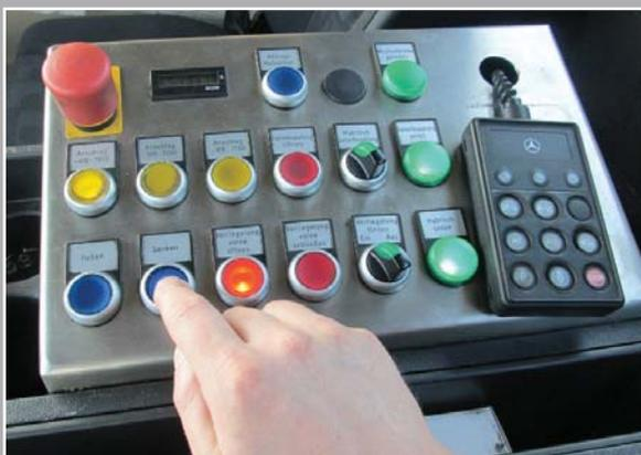
**A**us dem Fahrerhaus steuern Sie sämtliche Funktionen des Hubtisches sowie die hydraulische Sattelkupplung. Die hydraulische Sattelkupplung erleichtert Ihnen den Umschlag von Sattelaufliegern wesentlich. Ein Aussteigen ist nur noch für das Anschließen der Versorgungsleitung (Beleuchtung und Bremse) des Sattelauflegers/Anhängers erforderlich.
