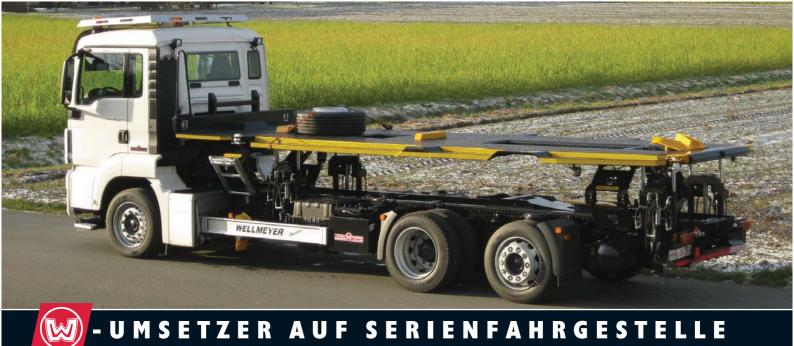
Aus dem Fahrerhaus steuern Sie sämtliche Funktionen des Hubtisches sowie die hydraulische Sattelkupplung.
