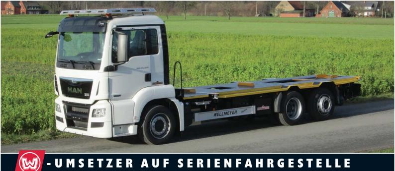
Der Umsetzer ist mit Funktionalität ausgestattet, die sich an der Praxis orientiert. Eine stabile Bauweise und eine einfache und übersichtliche Bedienung helfen dem Fahrer bei seiner Arbeit mit Wechselbehältern. Die Stabilisierung der Plattform durch das Wellmeyer Scherensystem garantiert eine vertikale Führung in der Auf- und Abwärtsbewegung und hält die Wechselbrücke sicher
