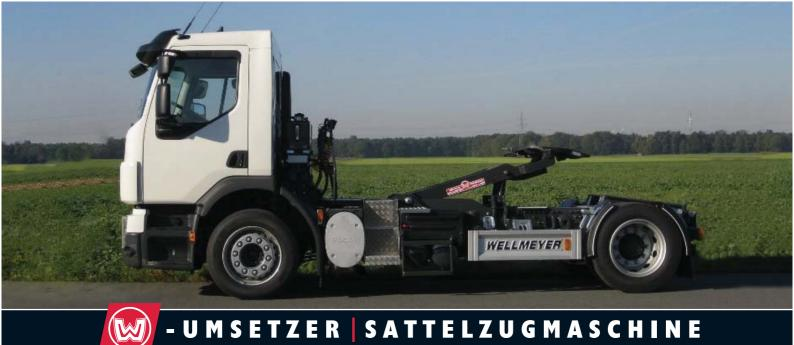
Der Umsetzer als Sattelzugmaschine verfügt über einen kurzen Radstand für höchstmögliche Wendigkeit. Außerdem ist er mit einer stabilen Sattelkupplung ausgestattet, die eine optimale Führung des Sattelaufliegers gewährleistet.
