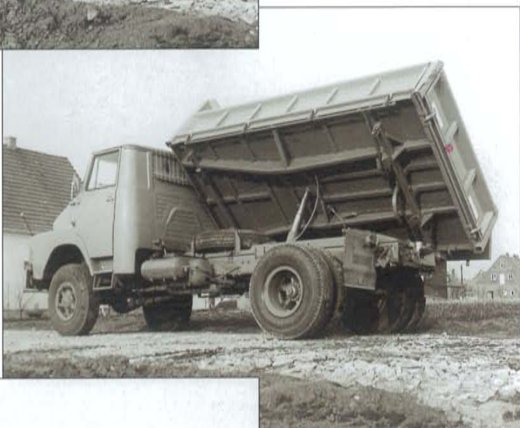
Henschel HS 16 HAK Allrad-Stahlreiseitenkipper mit automatischem Rückwandverschluss für den Einsatz beim Bau der neuen Autobahn A 1 „Hansa-Linie“
