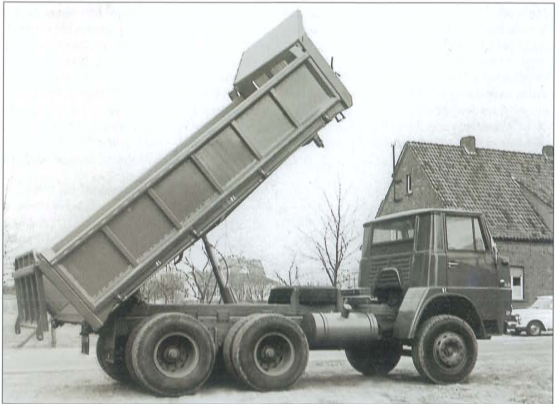
Henschel HS 22 TK Ganzstahlkipper. Zu diesem Zeitpunkt ist diese Konzeption noch eine Besonderheit. Selbst der größere Konkurrent Meiller liefert nur mit Blech verkleidete Holzböden.
