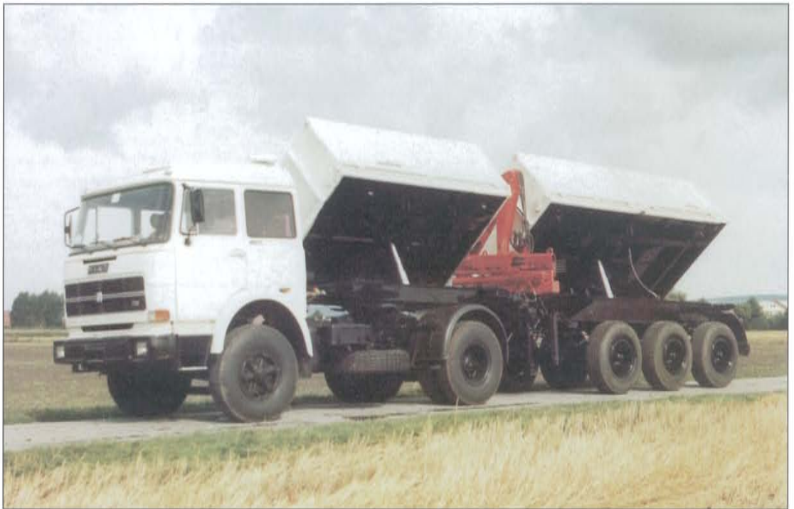
FIAT 170 NC Sattelzug für einen Betonsteinbetrieb. Der vordere Teil des Aufliegers ist als Zweiseitenkipper konzipiert und der hintere Kasten als Dreiseitenkipper. Dazwischen ist ein Ladekran montiert.
