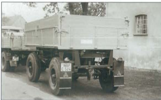
Dreiseitenkipper für 10 t Gesamtgewicht Ende der fünfziger Jahre
