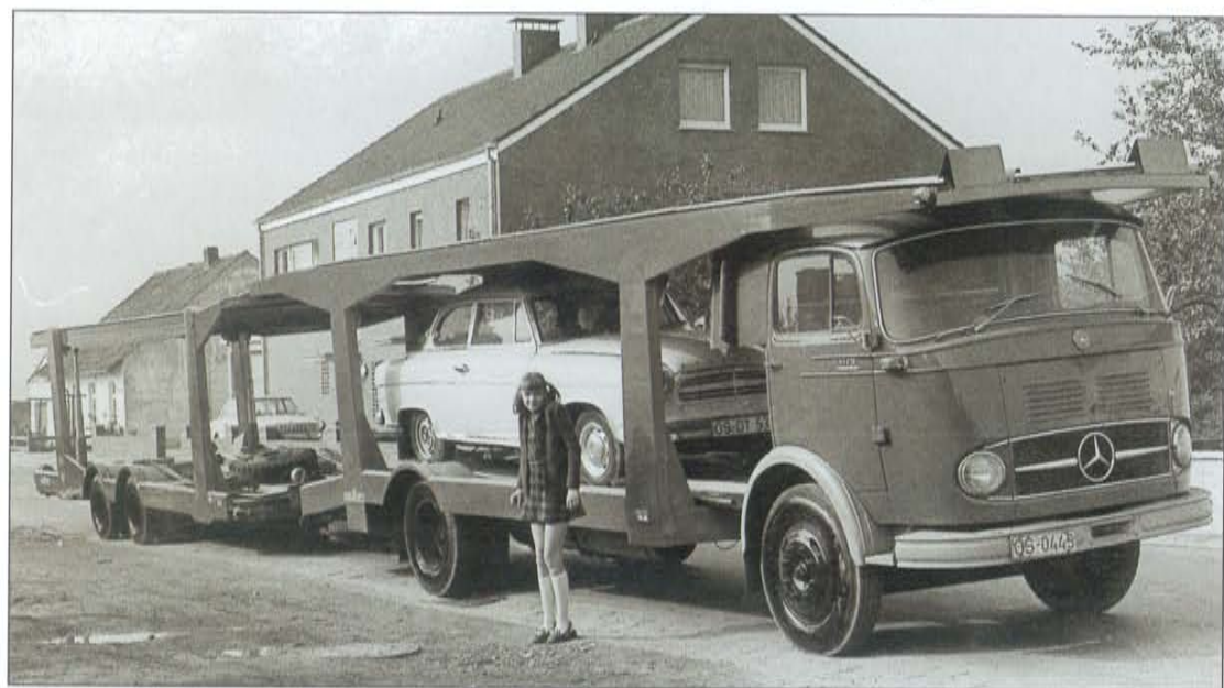
Mercedes LP 1113 Autotransporter mit „Schwalbennest“-Schlafkabine hinter dem serienmäßigen Fahrerhaus
