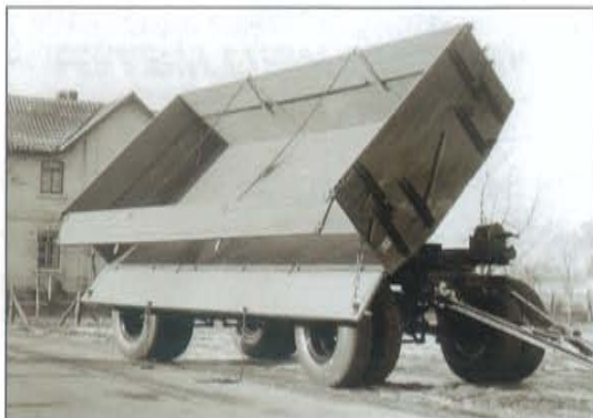
Kipper mit horizontal geteilter Bordwand aus den fünfziger Jahren
