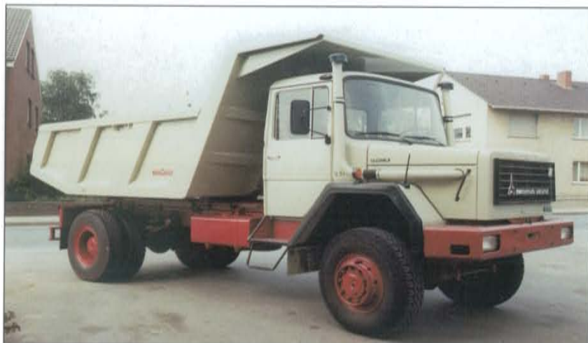
Mercedes LPS 2032 mit zwei lenkenden Achsen. Der Auflieger besitzt zwei separat bedienbare Kippbrücken.
