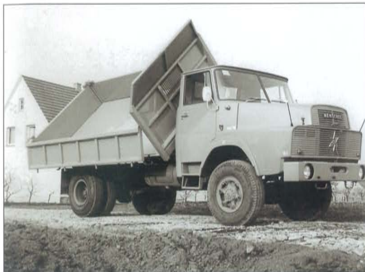
Henschel HS 16 HAK Allrad-Stahlreiseitenkipper mit automatischem Rückwandverschluss für den Einsatz beim Bau der neuen Autobahn A 1 „Hansa-Linie“
