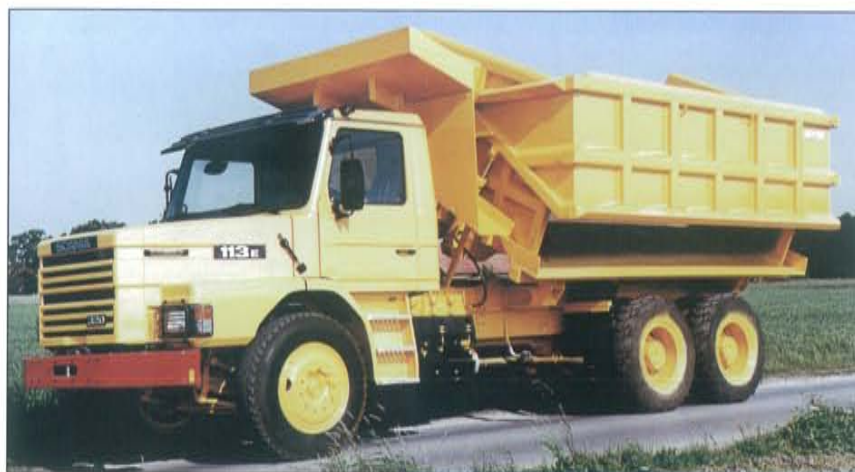
Einseitenkipper für Kalkwerke in Paderborn auf Scania T 113 E mit 320 PS-Motor
