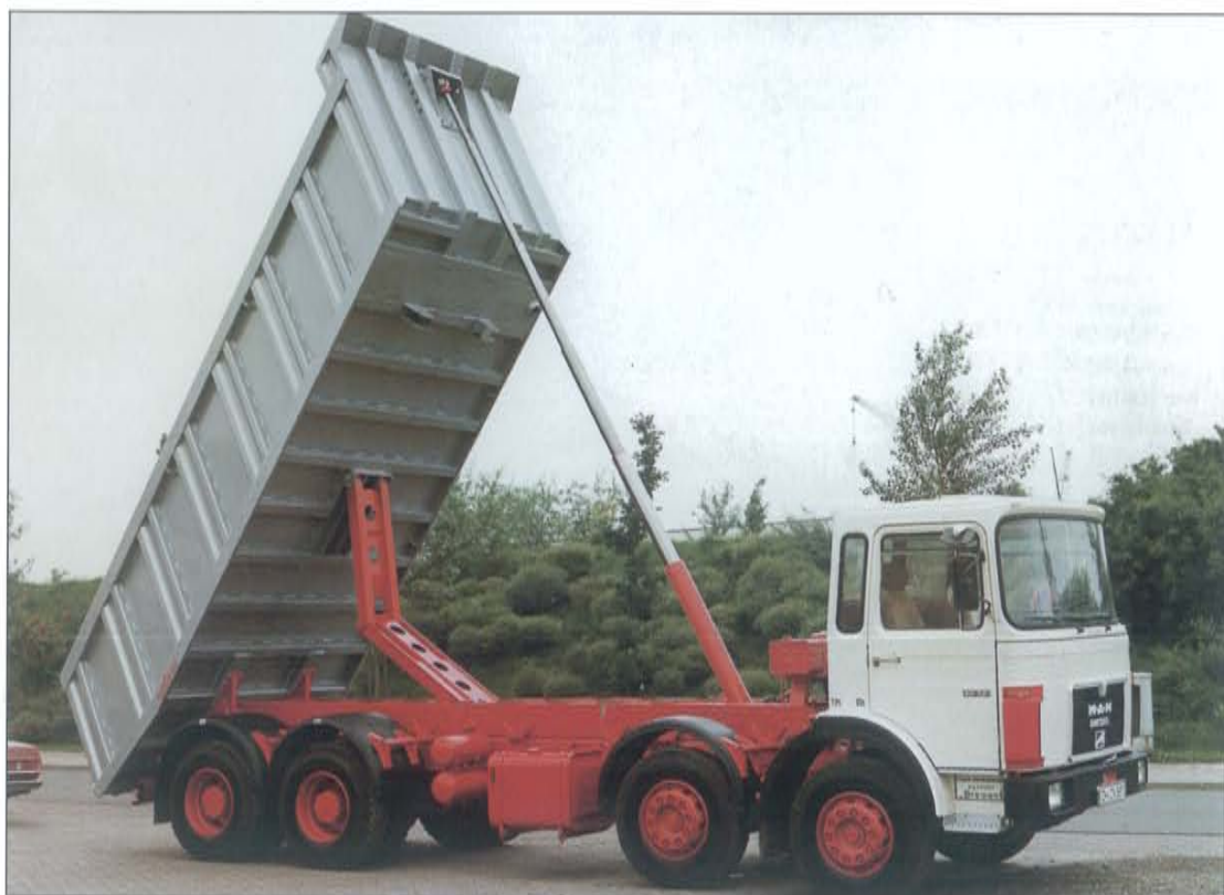
Hinterkipper mit Frontstempel auf MAN 30.321 VFK
