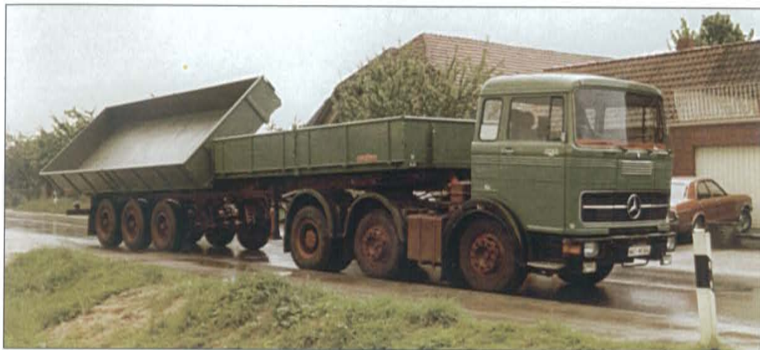
Mercedes LPS 2032 mit zwei lenkenden Achsen. Der Auflieger besitzt zwei separat bedienbare Kippbrücken.
