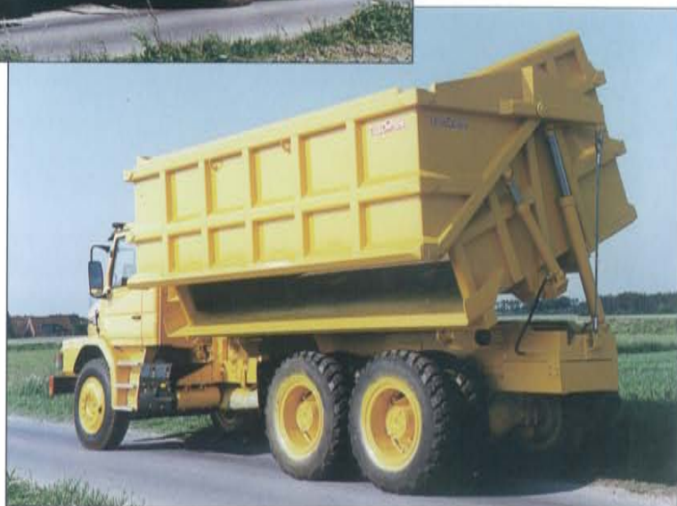
Einseitenkipper für Kalkwerke in Paderborn auf Scania T 113 E mit 320 PS-Motor
