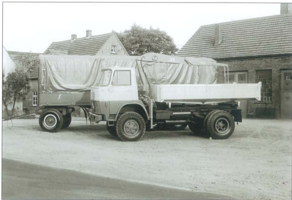
Henschel HS 16 TAK Allrad-Dreiseitenkipper mit HIAB-Ladekran
