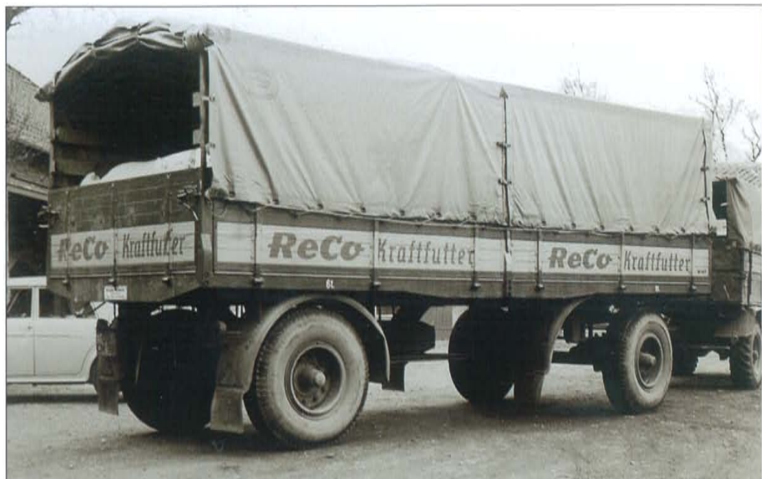
12-Tonner (zwei 6 t-Achsen) für den Landhandel mit vorgespanntem Unimog
