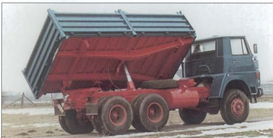
Magirus 310 D 16 FAS mit Allradantrieb und Stahl-Dreiseitenkipper von W. Wellmeyer
