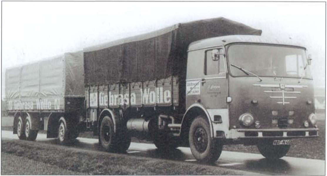
Büssing Commodore U der Spedition Mussmann in Sassenberg mit W. Wellmeyer Dreiachs-Anhänger
