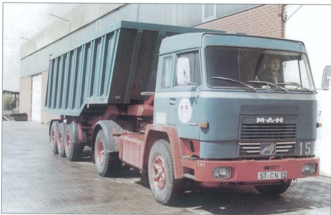
MAN-Büssing 16.320 mit stehendem 320 PS-Motor und Hinterkipp-Auflieger von W. Wellmeyer
