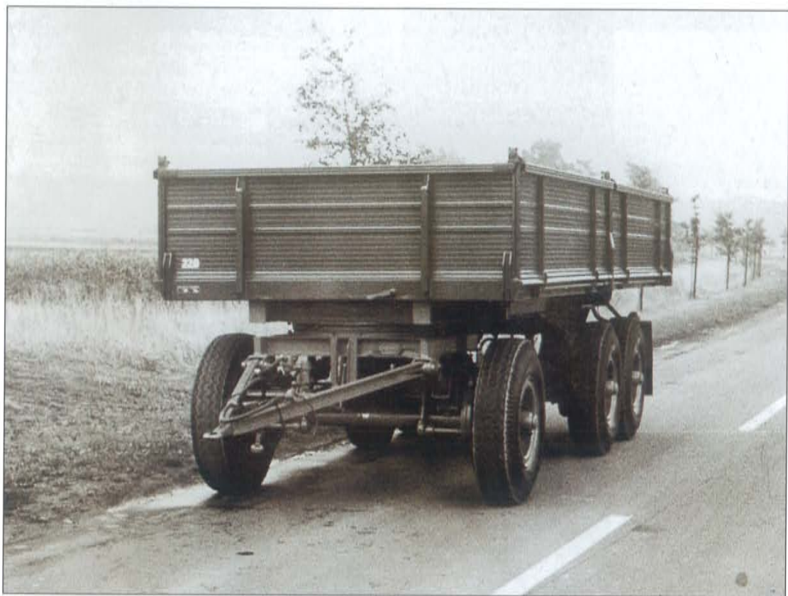
Dreiachs-Dreiseitenkipper für 22 t Gesamtgewicht
