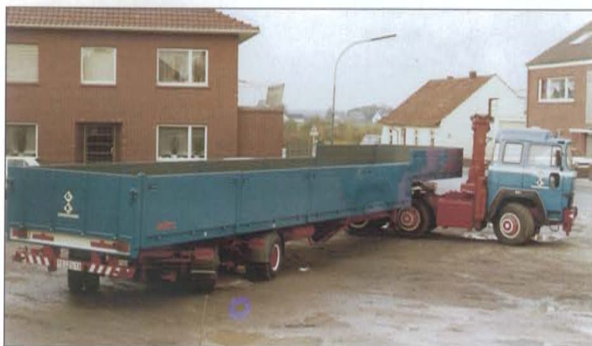
Trotz seiner imposanten Länge ist dieser Sattelzug durch zwei mittlenkende Aufliegerachsen und zwei lenkbare Achsen an der Magirus-Zugmaschine extrem wendig.
