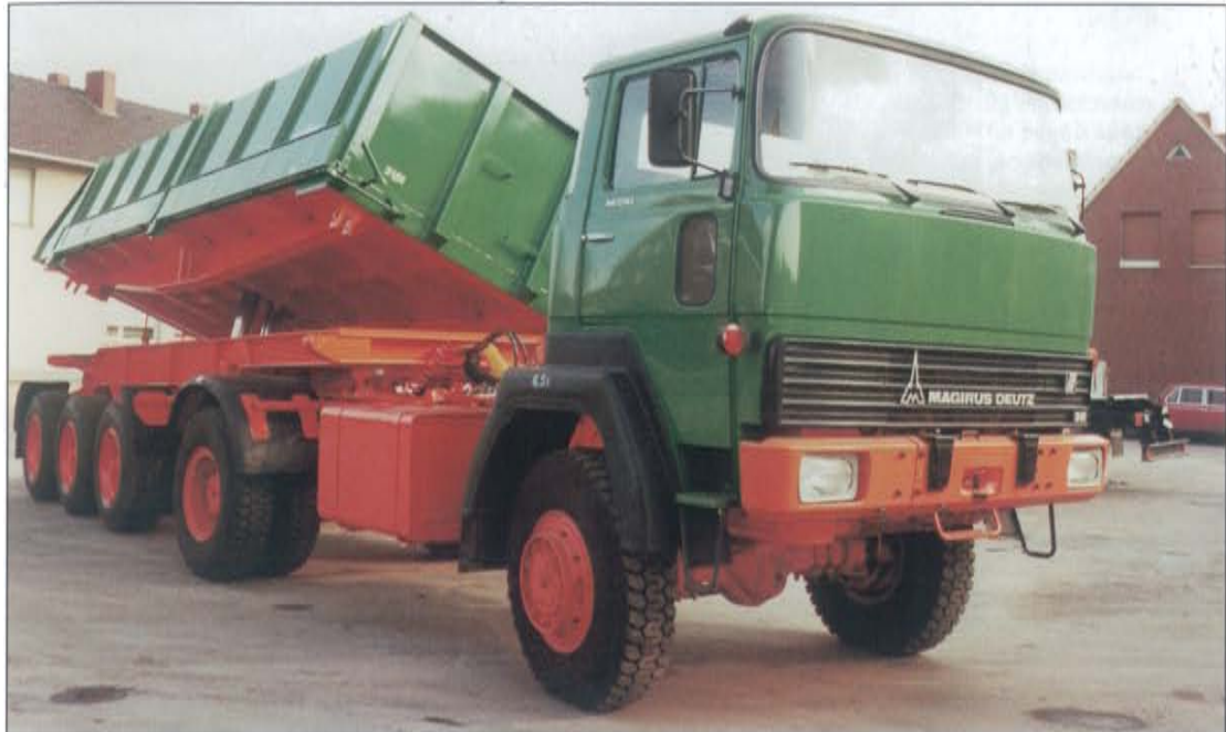
Magirus 310 D 16 FAS mit Allradantrieb und Stahl-Dreiseitenkipper von W. Wellmeyer
