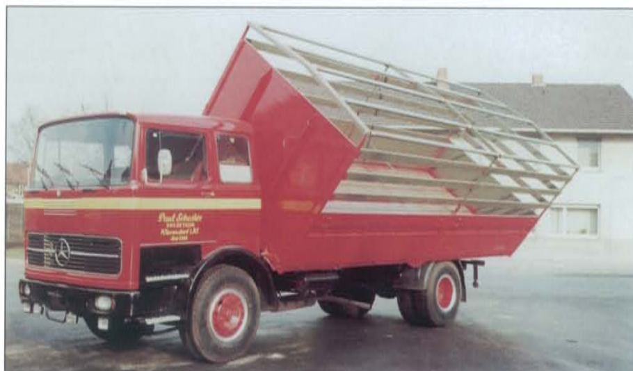
Mercedes LP-Modell mit kippbarem Planenaufbau
