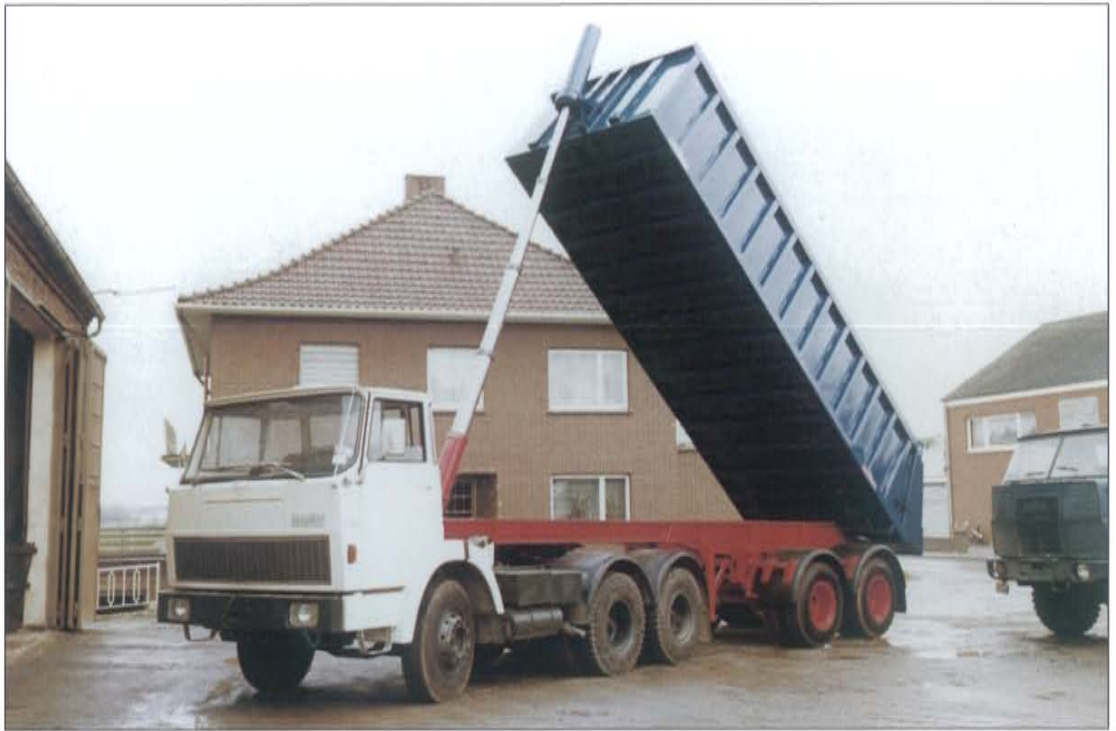
Hanomag-Henschel F 221 S von etwa 1973 mit Hinterkipp-Auflieger und Frontpresse
