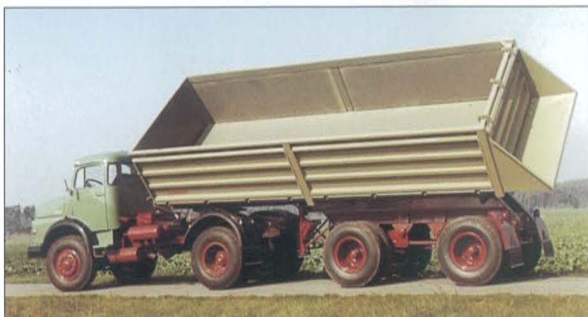
Mercedes LAS 1623 Allrad mit Stahl- Dreiseitenkipp-Auflieger
