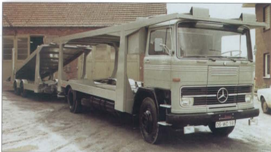
Mercedes LP 1519 Autotransporter mit Schlafkabine hinter dem feststehenden Fahrerhaus
