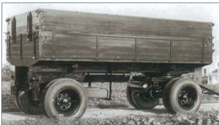
Dreiseitenkipper mit Zwillingbereifung rundum zu Beginn der fünfziger Jahre
