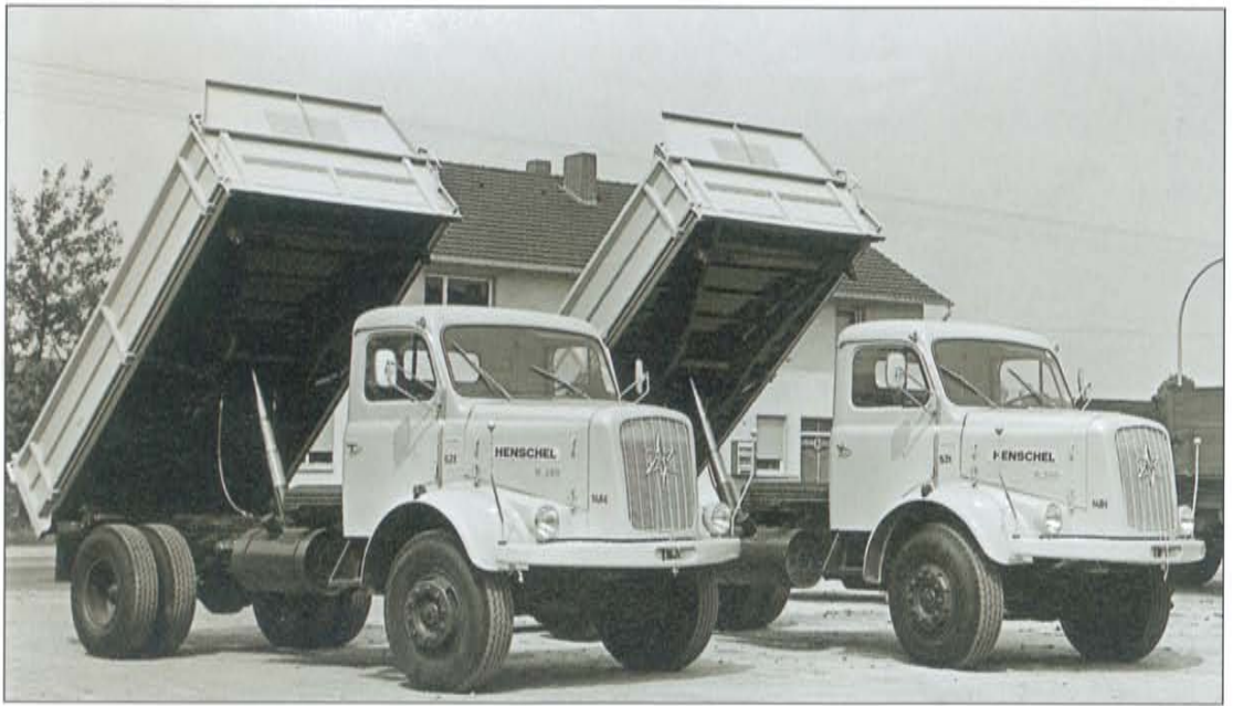
Henschel H 140 AK (Gesamtgewicht 14,6 t) mit W. Wellmeyer Dreiseitenkipper in Stahlkonstruktion
