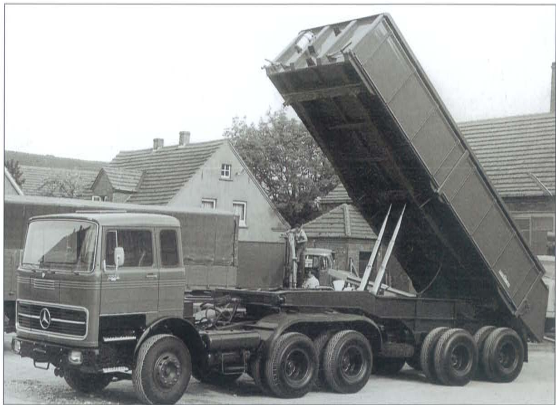
Mercedes LPS 2224 mit W. Wellmeyer Dreiseitenkippaufleger
